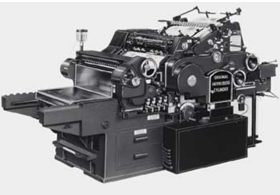
Das System ermöglichte einen besseren Druck und war vor allem deutlich schneller. Diese Maschinen wurden kontinuierlich verbessert, und dieses Druckprinzip hat sich dann auch für den Hochdruck weltweit durchgesetzt. Dass diese Maschinen mit dem Wechsel vom Bleisatz auf den Fotosatz ihre Bedeutung verloren und Offsetmaschinen (mit dem Prinzip „Rolle gegen Rolle“) ihre bis heute dominante Stellung übernahmen, war dann nur folgerichtig.
