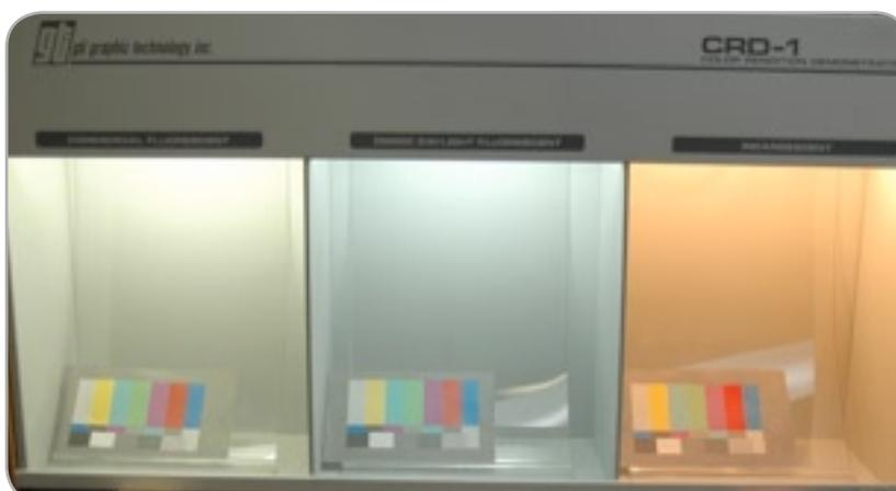
Abb. 37: Identische Prüfdrucke unter drei verschiedenen Lichtarten (links: Bürolicht, Mitte: D50-Simulator, rechts: Glühlampe)
