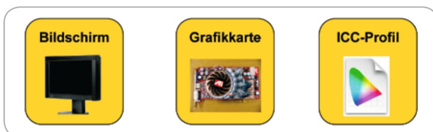
Abb. 14: Prinzipdarstellung der drei wichtigsten Komponenten für die Bildschirmansteuerung
