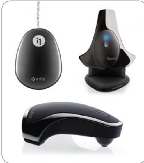
Abb. 29: Abbildung typischer Kolorimeter
